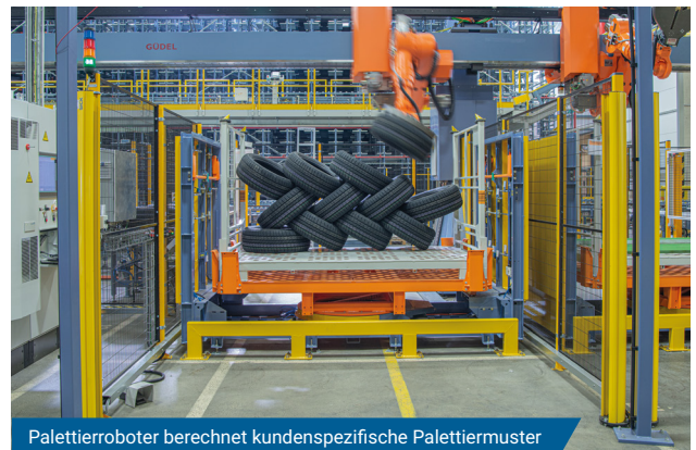
Palettierroboter berechnet kundenspezifische Palettiermuster
