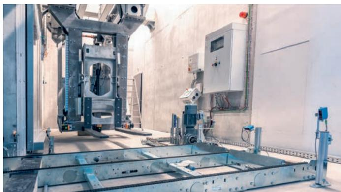
Über intelligente Sicherheitstechnik wird sichergestellt, dass sich keine Personen in der zu beladenden Kabine befinden, bevor die Waren in der Kabine platziert werden. Die Genauigkeit der Kabinenposition am Beladepunkt beträgt +/- 10 mm. Die Be- und Entladung in der Tal- und Bergstation geschieht vollautomatisch.
