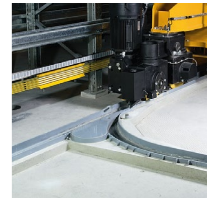
Das Regalbediengerät stellt die Weiche während der Fahrt mit dem Schaltkeil – ohne Verzögerung, Überwachungs- und Stellwerkaufwand.
