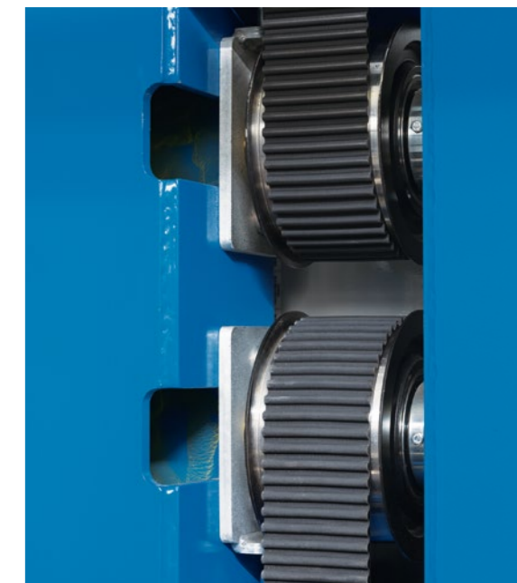
Patentierte Kombination zweier Klassiker der Mechanik: Der bruchfeste Zahnriemen wird nach dem Flaschenzug-Prinzip umgelenkt und stemmt damit Gewichte von mehreren Tonnen.
