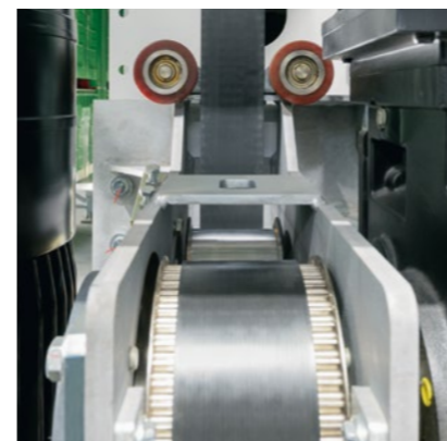
Die mehrfach höhere Lebensdauer des LTW Antriebsriemens gegenüber konventionellen Seiltrieben bewirkt wesentlich geringere Lebenszykluskosten.
