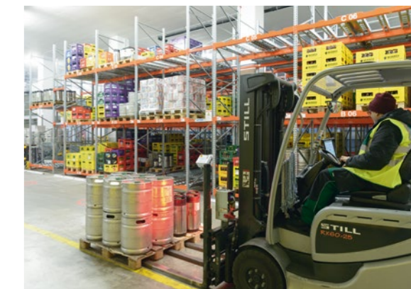
Ausführungsdetail: LTW rüstet die Stapler am Warenausgang mit einer Kamera zum automatischen Etikettenscan inklusive WLAN-Anbindung zum Lagerleitsystem auf.
