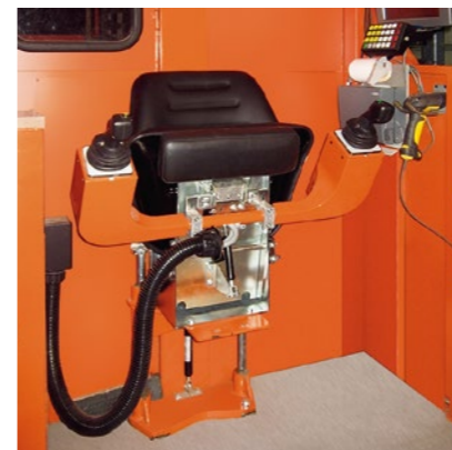
Der neu entwickelte Klappsitz mit schwenkbaren Joysticks sorgt als Stehsitz auch im Kommissionierbereich des Lagers für ergonomisches Arbeiten.
